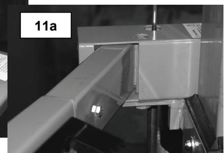
2. Bedienarm einsetzen und das Rohr in die Aussparung der Querverbindung einführen. (Abb. 11)
