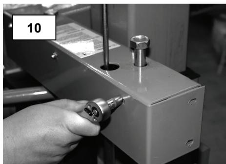
1. Schrauben Sie die Bedienarmkonsole ab (Abb. 10)
