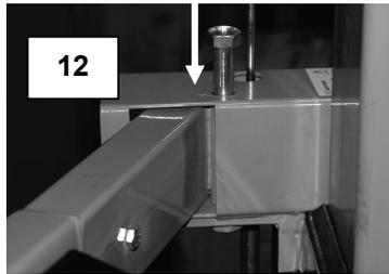
3. Nun schieben sie die Schrauben von oben durch die Bedienarmkonsole und den Bedienarm. (Abb. 12)
