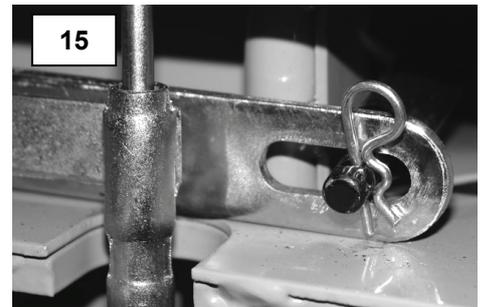
Stecken Sie jetzt noch die mitgelieferten Splinte auf der Rückseite der Bedienarmkonsole wie in (Abb. 15) zu sehen ein.
