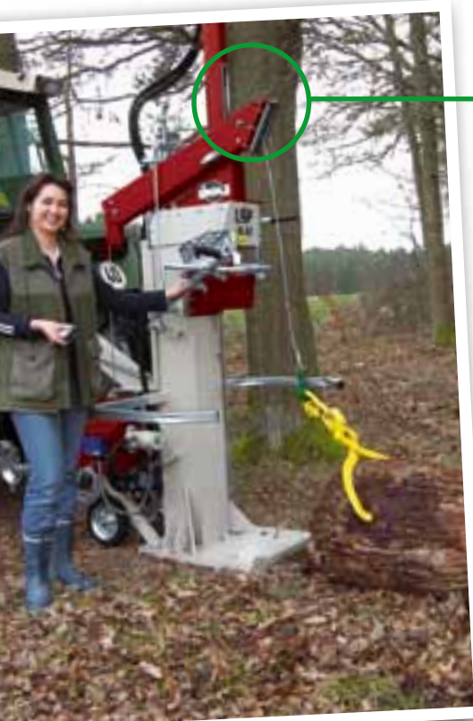
Endabschaltung zur Sicherheit des Bedieners!
