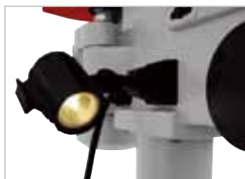
Eine seitlich angebaute Bohr- tischbeleuchtung zählt zur Serienausstattung.
