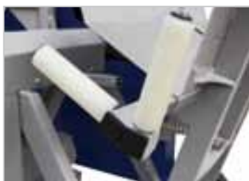
Ausziehbare Rollen für Holzzuführung.
