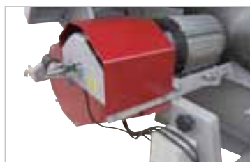
Antrieb durch leistungsstarken E-Motor mit 7,5 kW P 1 S6 40% ED (WTK 710 EZ)
